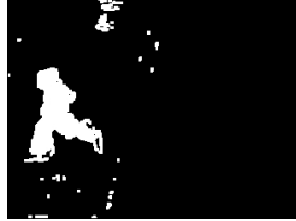
Figura 3 – Máscara obtida para os dois primeiros quadros com limiar de subtração igual a 20.
