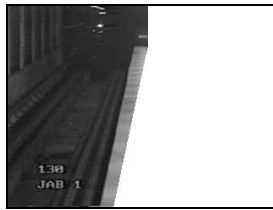
Figura 1 – Máscara de subtração do fundo. A área em branco não será processada.
